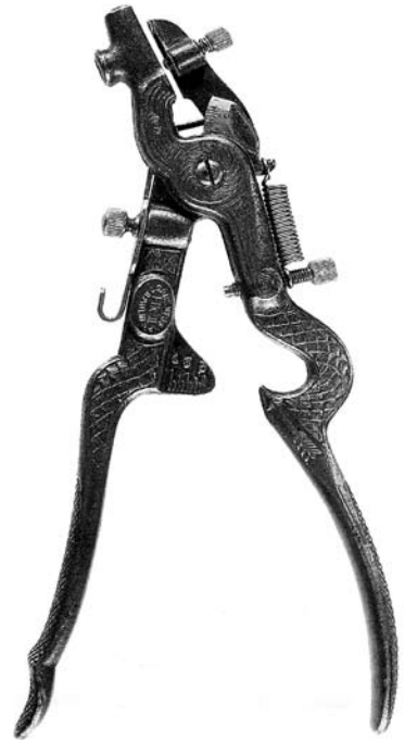
Schränkzange Winkel- und Tiefenanschläge verstellbar Deutschland, 20. Jh.
