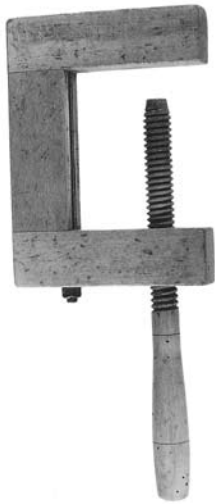
Schraubzwinge aus Holz mit Zugschraube
