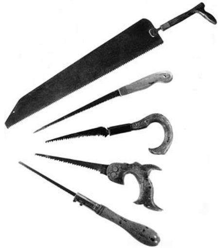
Stoßsäge und Stichsägen 19. Jh. und 20. Jh.
