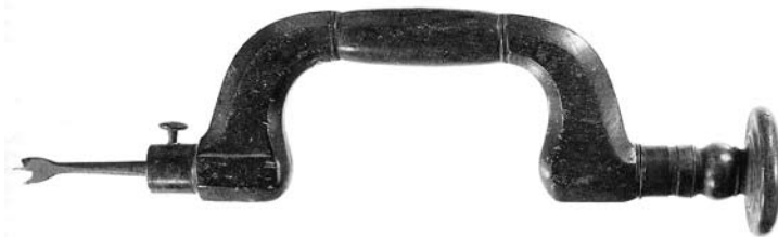
Hölzerne Bohrwinde Einsatzfixierung federnder Stift, Schweiz, 19. Jh.
